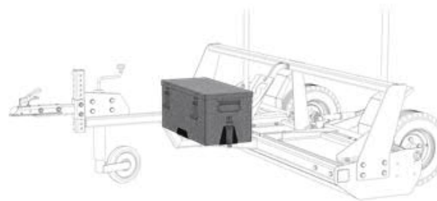
Debris container module
